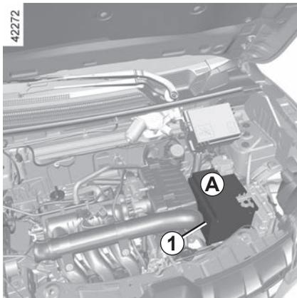
A bateria **1** não requer manutenção. **Não abra nem adicione líquidos de qualquer tipo.**
