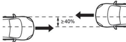
**Numa colisão frontal** com outro veículo de categoria equivalente ou superior, com uma zona de colisão igual ou superior a 40%, em que a velocidade de ambos os veículos seja igual ou superior a **40 km/h**.
