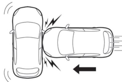
**Numa colisão lateral** com outro veículo de categoria equivalente ou superior, a uma velocidade de colisão igual ou superior a **50 km/h**.
