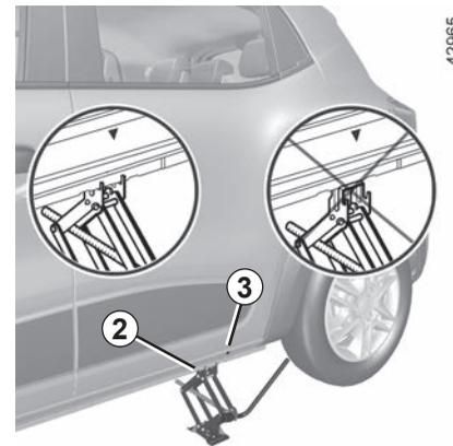
Coloque o macaco **2** sob a carroceria, alinhado com a marca de fixação **3** mais próxima da roda a substituir.
