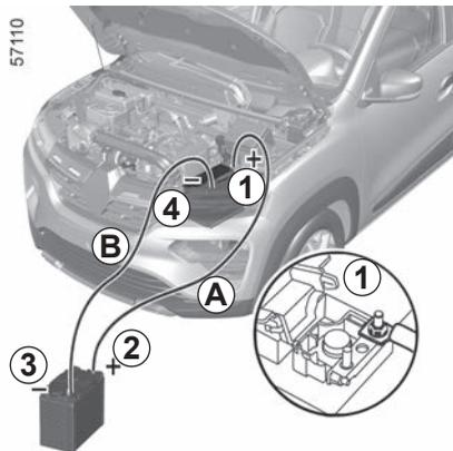
Fixe o cabo positivo (+) **A** ao borne (+) **1** da bateria descarregada e, a seguir, ao borne (+) **2** da bateria de alimentação de corrente.
