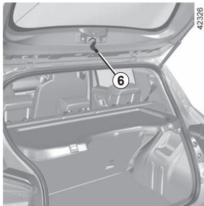
Gire o porta-lâmpadas 6 um quarto de volta, desencaixe e retire a lâmpada.
