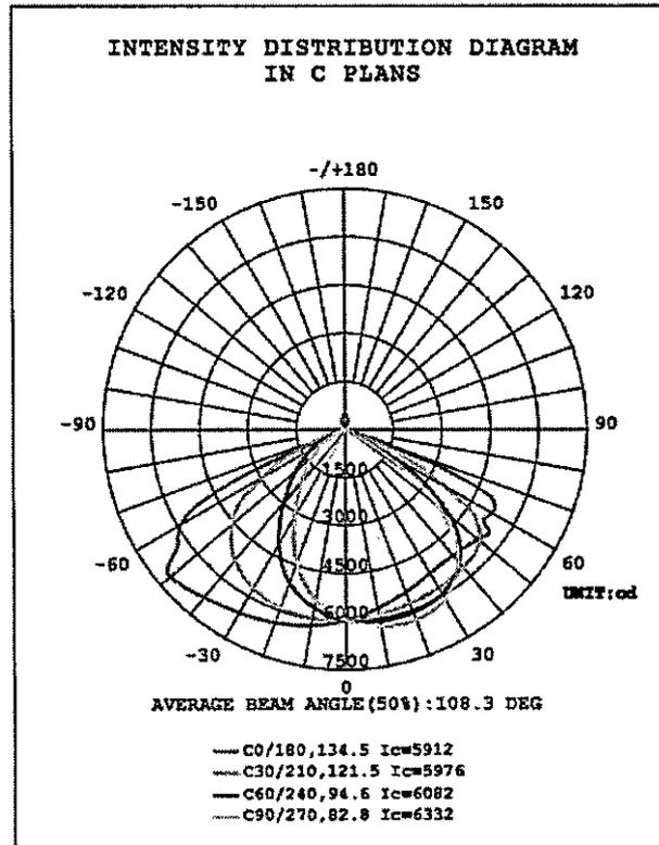
Figura 5 – Curva de distribuição de intensidade luminosa (Amostra 23).
