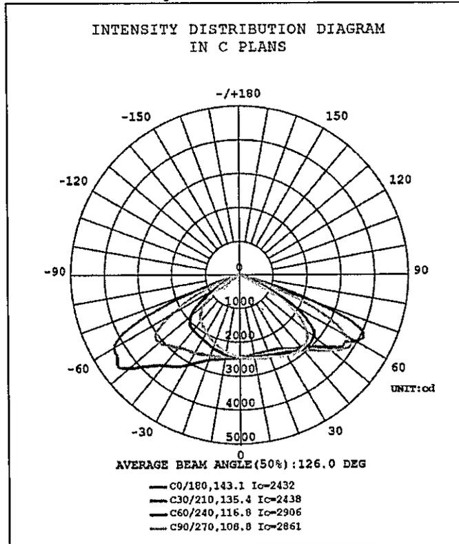
Figura 1 – Curva de distribuição de intensidade luminosa (Amostra 31).
