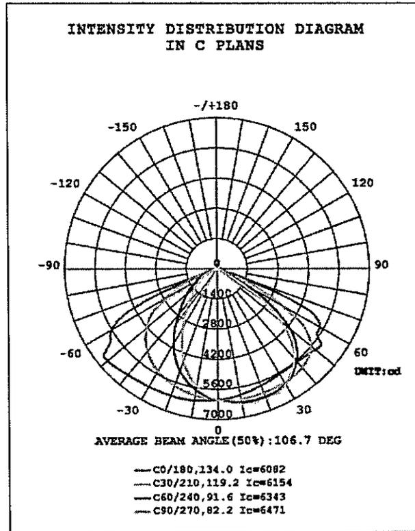
Figura 3 – Curva de distribuição de intensidade luminosa (Amostra 22).
