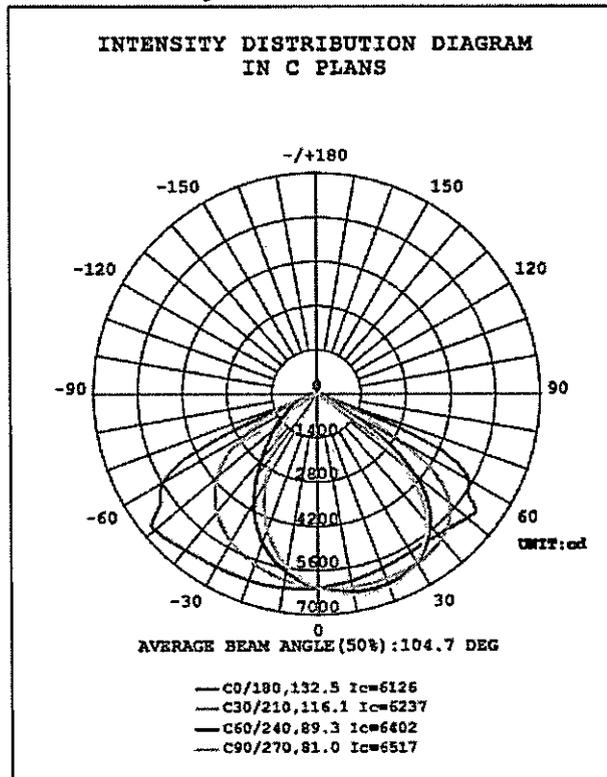
Figura 1 – Curva de distribuição de intensidade luminosa (Amostra 21).
