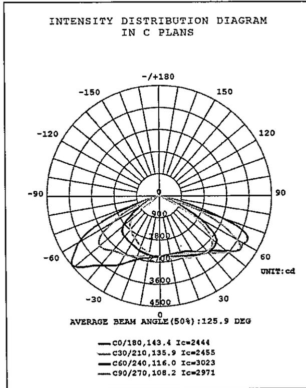
Figura 3 – Curva de distribuição de intensidade luminosa (Amostra 32).
