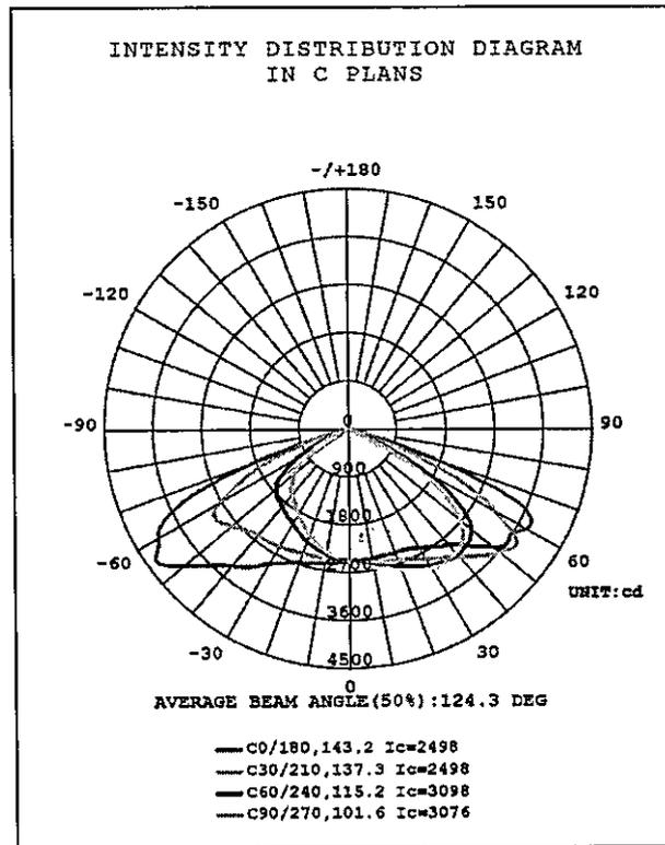
Figura 5 – Curva de distribuição de intensidade luminosa (Amostra 33).
