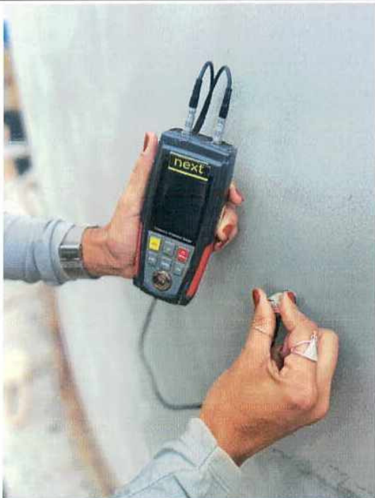
Medição de espessura
