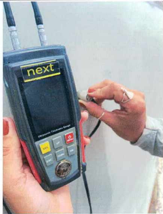
Medição de espessura
