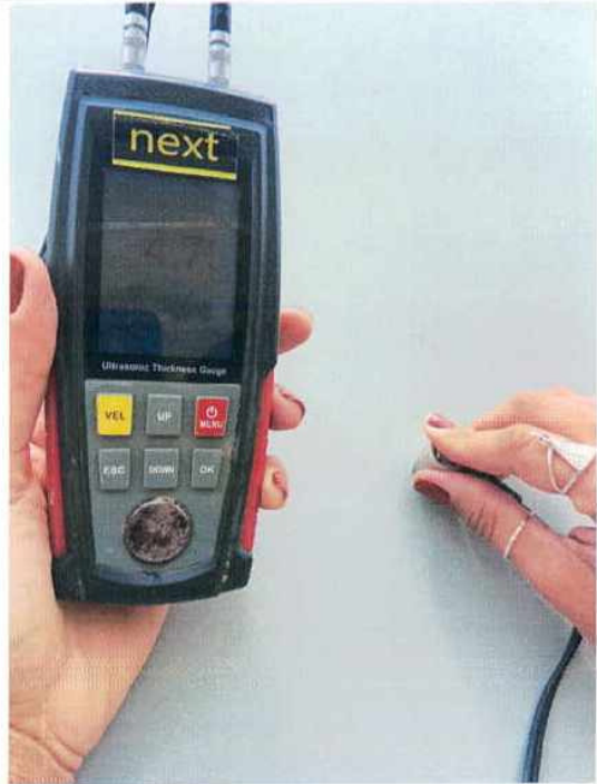
Medição de espessura
