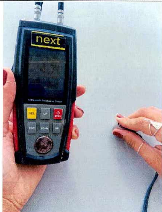
Medição de espessura
