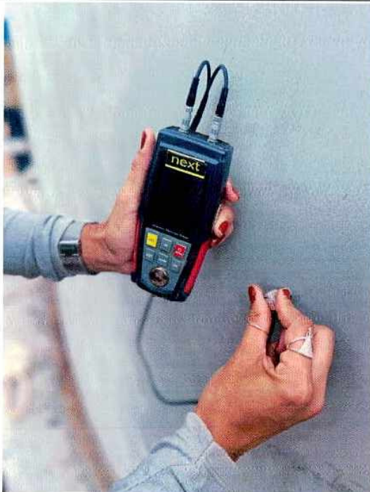
Medição de espessura
