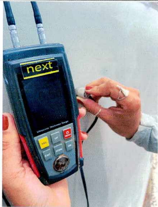
Medição de espessura
