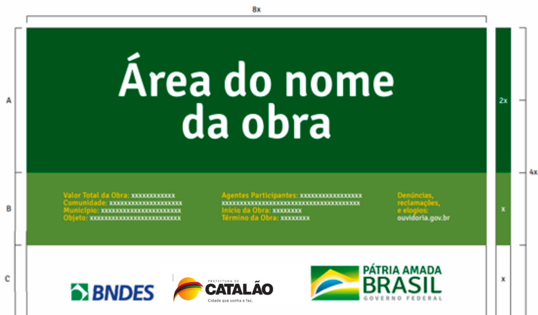
Figura 1: Modelo Placa de Obra- Padrão Federal- Dimensões: 3,44 x 2,16 metros
